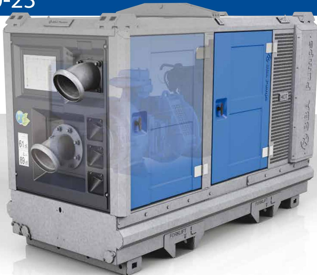
На основе многолетнего опыта компанией BVA Pumps разработан шумопоглощающий корпус M10-23. Данный корпус представляет собой раму M10-23 горячего цинкования и композитные двери или панели. Шумопоглощающий корпус M10-23 существенно снижает уровень шума насосного агрегата. Легкий вес и компактные габаритные размеры корпуса (2270 x 1050 мм) обеспечивают удобство установки насосных агрегатов на месте эксплуатации и хранения.
