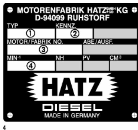
Табличка находится на картере или звукоизоляционном кожухе (разд.2) и содержит следующие данные двигателя:
